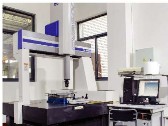
德国蔡司三坐标测量仪
